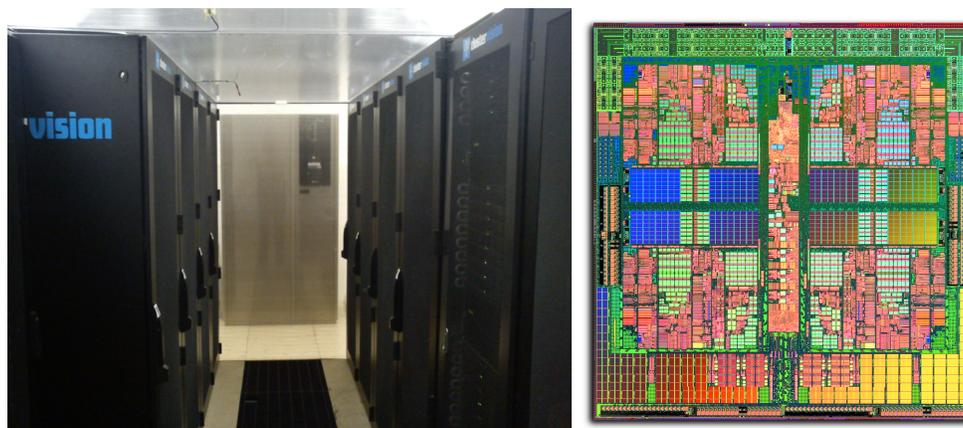
Figura 5.2: Una foto del cluster Matrix a sinistra, mentre sulla destra particolare dell'architettura Quad-Core dei processori Opteron che equipaggiano il Matrix.
